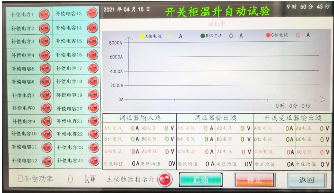
图十：开关柜温升试验 自动试验界面
